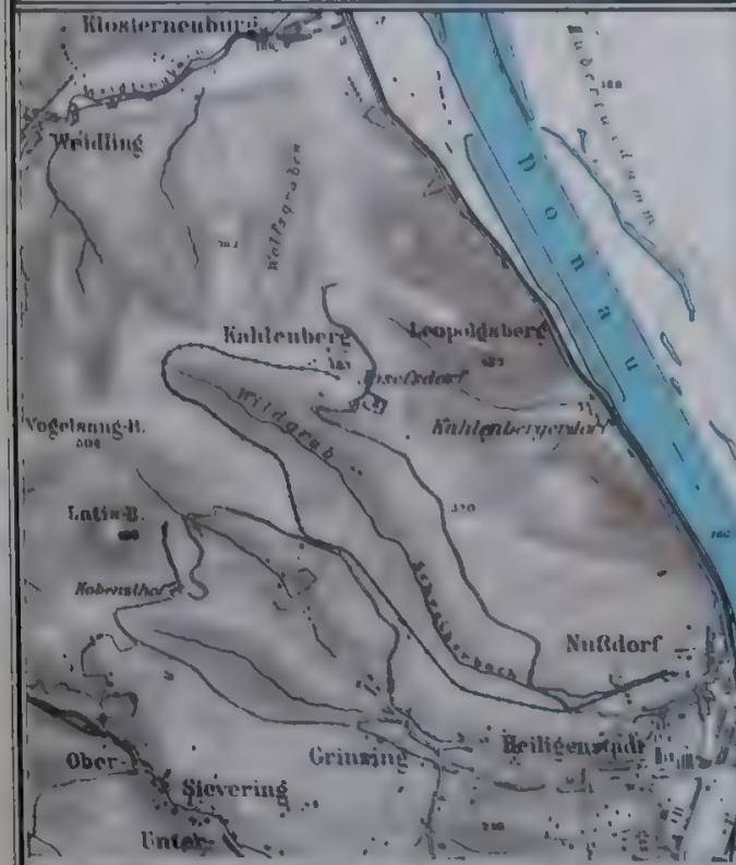
3. Böschungsschraffen in senkrechter Beleuchtung Die Striche laufen i.d. Richtung des Wasserabflusses ihre Stärke wächst im Verhältnis zur Steilheit der Böschung
